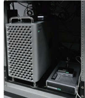
MA1 のオーディオ/映像システムを1台で賄う最新の Mac Pro
